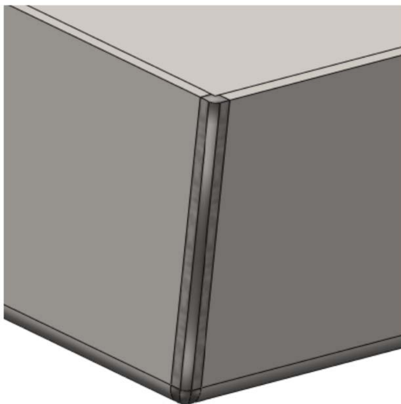
Рис. 1.4. Создание сварного соединения в угловых стыках
